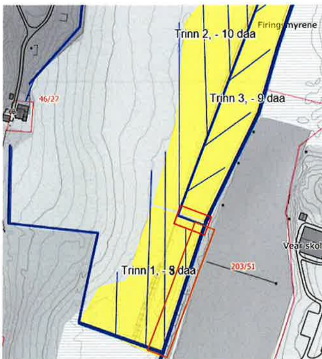
Figur 2. Skisse for drenering av området «Trinn 1». Rød markering viser den delen av åpen grøft som må etableres før matjorda legges ut på «Trinn 1». Brun markering viser den delen av kanalen som minimum må renskes opp. Skisse modifisert fra NLRVs dokument.
